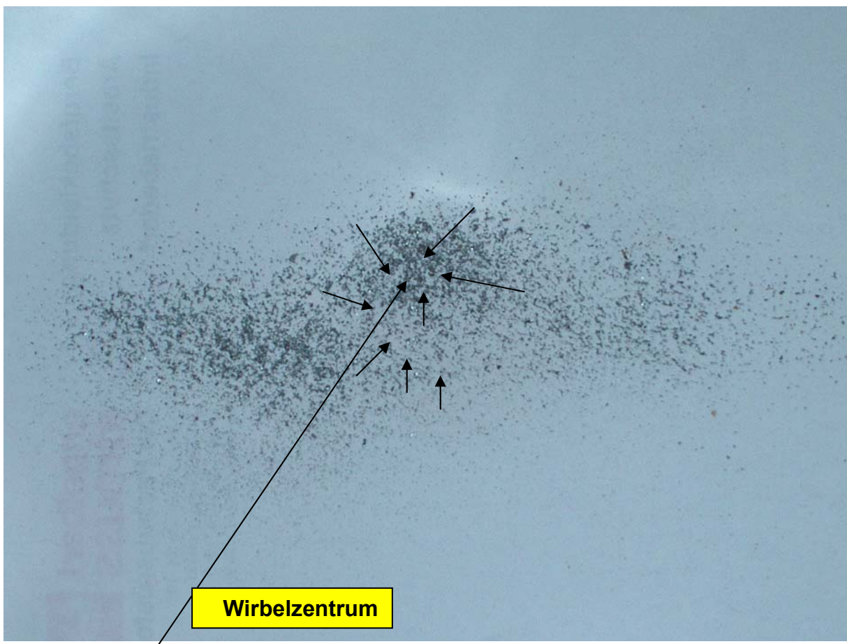
Bild 5: Strukturbildung in Eisenfeilspänen
