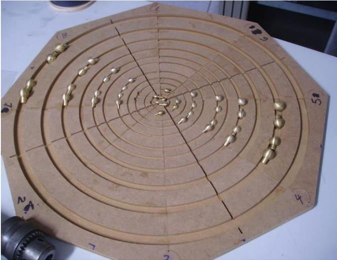
Bild 13: Schablone zum manuellen Formen der Dipolringe des MWOs
