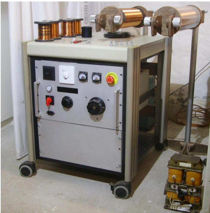
Bild 8: MWO als Eigenbau, im unfertigen Zustand
